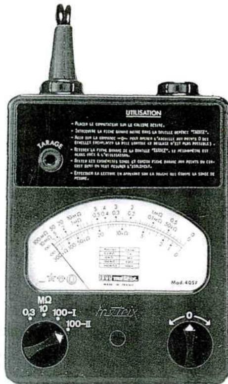
Os ohmímetros são aparelhos que, por leitura directa, nos indicam o valor da **resistência eléctrica** ligada aos seus terminais. Empregam-se com duas finalidades:
