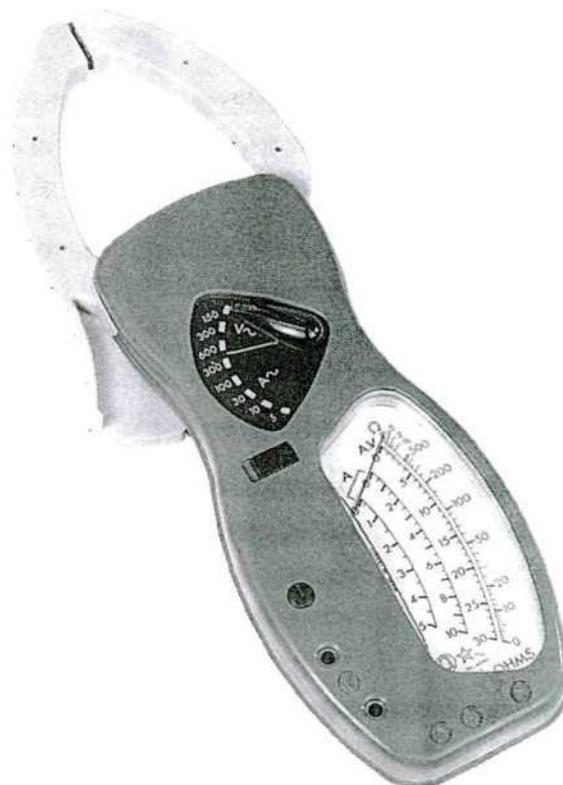
Multímetro / pinça amperimétrica
